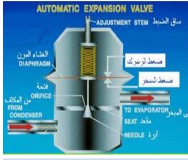
أجزاء وطريقة عمل صمام التمدد الأوتوماتيكي
