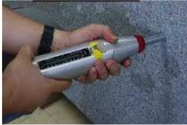
الصورة رقم (23): مطرقة شميدت Schmidt Hammer
