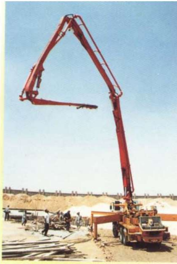
صورة رقم (5): خلاطه موقع سعة 0.75 م 3 صورة رقم (6): ماكينة ضخ خرسانة - 42 م
