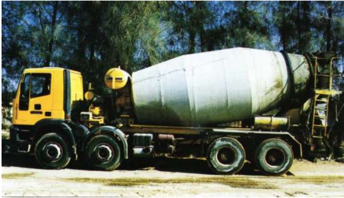
صورة رقم (4): عربة خلط خرسانة سعة 10 متر مكعب
