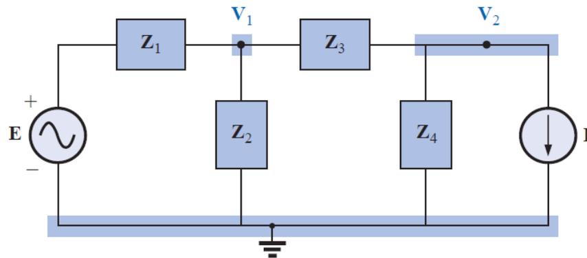
$$V_1 \left[ \frac{1}{Z_1} + \frac{1}{Z_2} + \frac{1}{Z_3} \right] - V_2 \left[ \frac{1}{Z_3} \right] = \frac{E_1}{Z_1}$$
