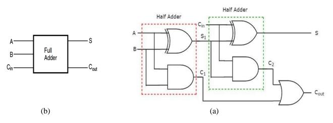
(a) الدائرة المنطقية التي تمثل Block diagram) مخطط الكتلة (b) Full Adder) لدائرة (a)
