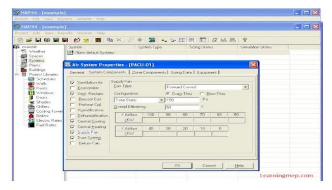
ثم من القائمة Duct System الخاصة بنظام توزيع الهواء (دكتات الهواء) حدد القيمة التقريبية للكسب الحراري للدكت كنسبة مئوية (ولتكن 2 %) والقيمة التقريبية لتسرب الهواء من الدكت (ولتكن 3 %) وكذلك هذه النسب تحتاج لخبرة وتتأثر بنوع وجودة العزل وجودة تركيب الدكتات.
