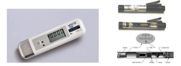
مقياس الجرعات للتخزين الأيوني المباشر :Direct Ion Storage dosimeter
