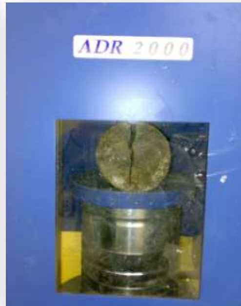
الصورة رقم (22): فحص العينة في جهاز فحص الانضغاط للخرسانة
