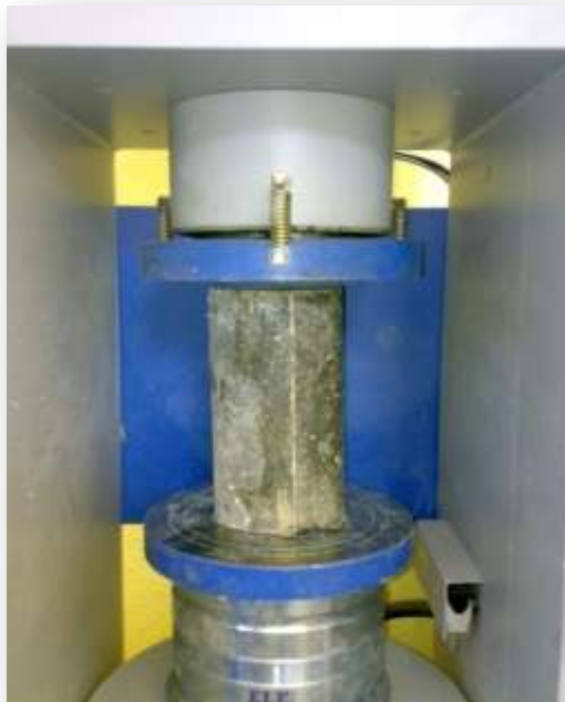
الصورة رقم (22): فحص العينة في جهاز فحص الانضغاط للخرسانة
