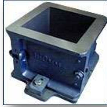
الصورة رقم (18): قالب لمكعب خرساني
