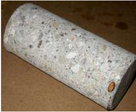
الصورة رقم (21): أخذ العينة من الخرسانة المتصلبة لعتبة من الخرسانة المسلحة
