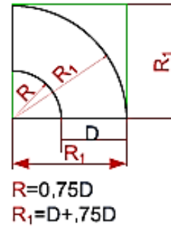
تفصيل 2 تفرع مجرى الهواء
