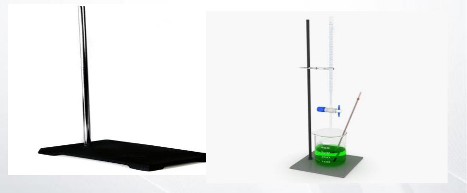
Ring Stand Used to hold or clamp laboratory glassware and other equipment in place, so it does not fall down or come apart. حامل الحلقة يستخدم لتثبيت أو تثبيت الأواني الزجاجية لا تسقط أو تتفكك. للمختبر وغيرها من المعدات في مكانها ، بحيث لا تسقط أو تتفكك.
