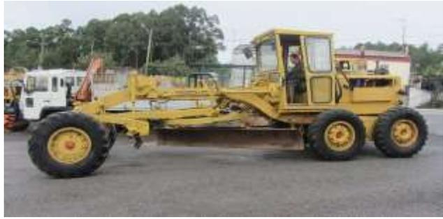
اللة تستعمل في فرش التراب او الحجر المكسر وكذلك في تسوية السطوح وتشكيلها وفق مناسب معينة ويكون ذلك بواسطة نصل متحرك افقيا و عموديا بين محوري عجلات الالة. بإمكان الالة قشط التربة الرخوة لأعماق بسيطة، ولا تستعمل هذه الالة في الحفر أو دفع التربة لمسافات طويلة بل تستعمل في انهاء السطوح كما ورد سابقا.
