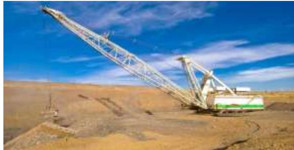
وهي من المعدات ذات الابراراج ايضا وتستعمل في حفر وتحميل التربة الرخوة أو المغمورة بالمياه الجوفية. تعتمد هذه الماكينة في الحفر والتحميل على اسقاط الدلو فوق المنطقة المراد
