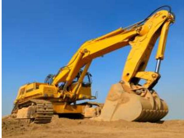
تستعمل لحفر وتحميل التربة بكميات كبيرة وعندما يكون عمق الحفر كبيرا نسبيا أو عندما تكون التربة حصوية ومتصلدة (cemented gravel) او طينية مرصوفة لا يمكن حفرها بسهولة بأنواع اخرى من المعدات وكذلك في حالات التربة التي تبقى جوانبها سليمة بدون انهيار . ان سرعة تحميل الأتربة بواسطة الماكينة اعلى من بقية المعدات ويمكن التحكم فيها بدقة اكبر.
