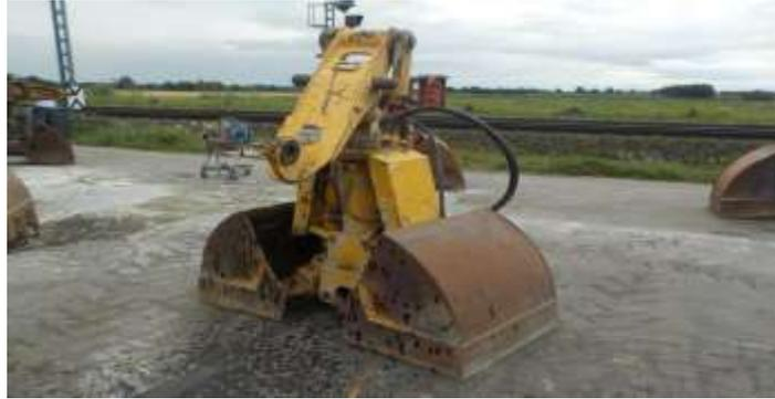
وهو من المعدات ذات الأبراج ويستعمل غالبا في رفع التربة من داخل الحفريات بصورة عمودية عندما تكون جدران الحفريات مسندة والتربة رخوة ورطبة أي انها مفضلة الاستعمال في الحفريات في المناطق المحددة وعندما ترفع التربة عموديا . تستعمل هذه الآلة كألة مساعدة لحفارات اخرى اكثر انتاجية وذلك لرفع المخلفات التي تتركها تلك الحفارات حيث أن انتاجية الدلو المحاري منخفضة نوعا ما.
