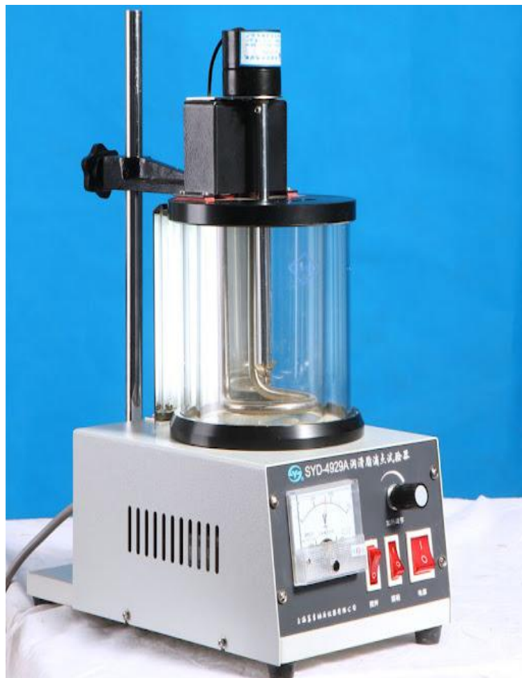
Fig.2 : Drop point apparatus .
