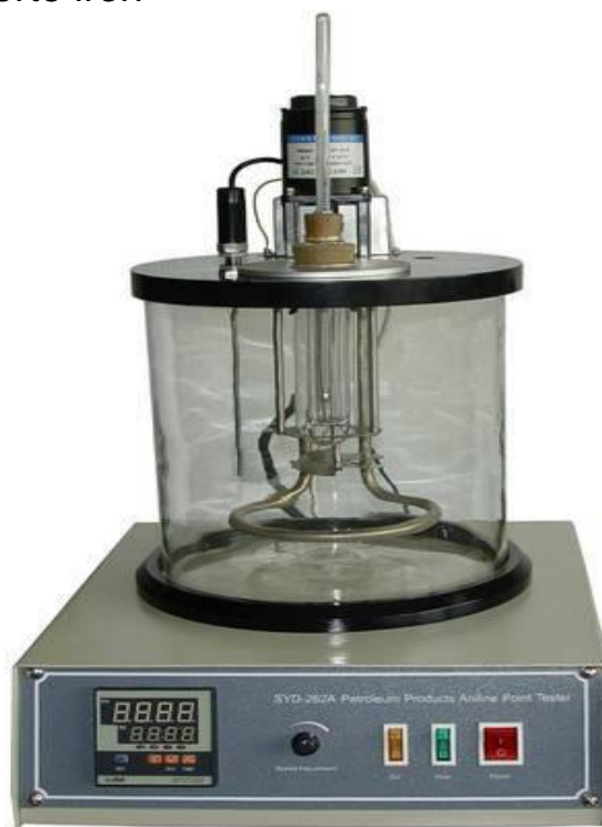
Fig.1 : aniline point apparatus
